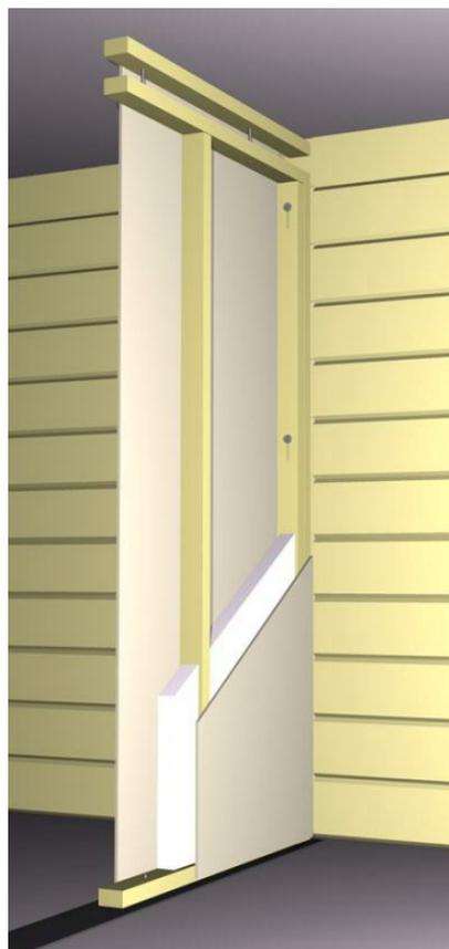
Рис. 11. Пример соединения легкой кардасной перегородки с бревенчатой стеной.
